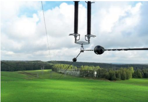
Das Projekt wurde mit einem Feldtest in der Nähe von Chemnitz abgeschlossen. Unter der Leitung und Finanzierung von MITNETZ STROM wurde das Vorhaben nachfolgend in einem Pilotversuch fortgeführt. Dafür wurden im September 2014 59 Sensoren auf einer Hochspannungsfreileitung zwischen Harzgerode und Rieder installiert. Mit dem Pilotversuch soll die Zuverlässigkeit des Systems über einen längeren Zeitraum unter realen Bedingungen nachgewiesen werden.
