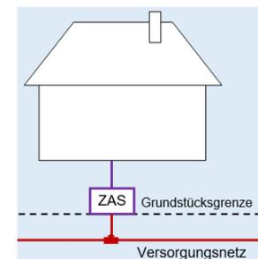
Bild 4 Zähleranschlusssäule (ZAS)
