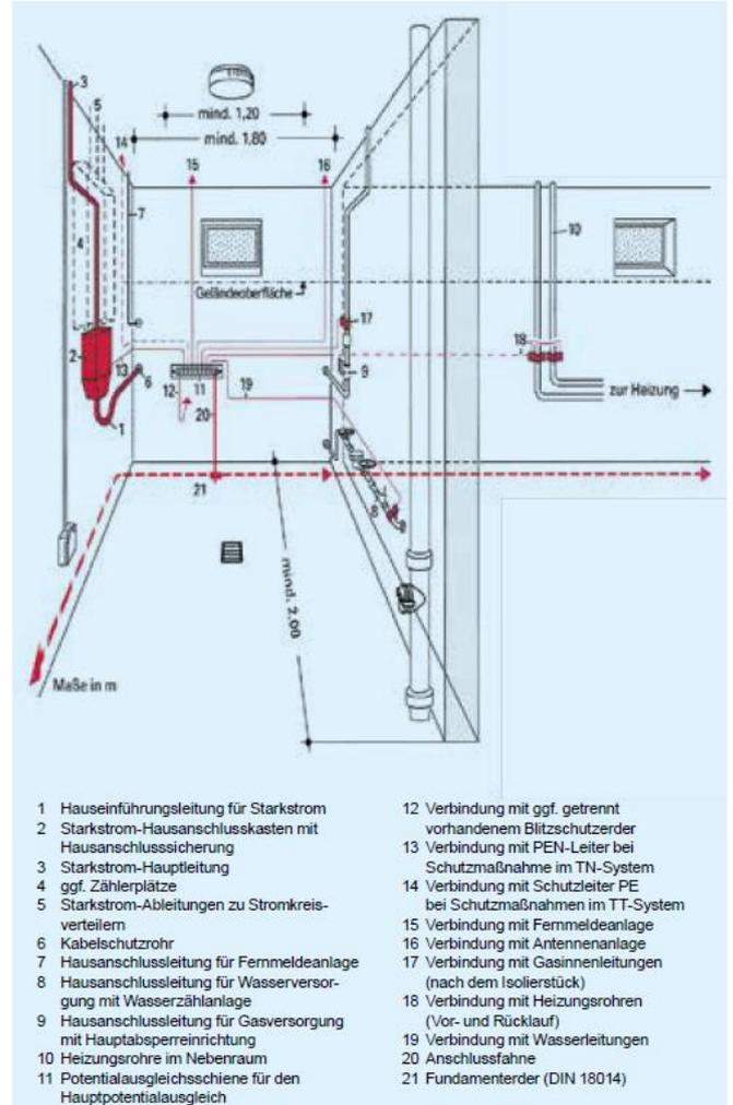
Bild 7 Beispieldarstellung: Hausanschlussraum
