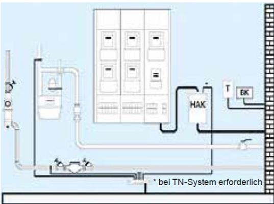
Bild 6 Beispieldarstellung: Hausanschlusswand
